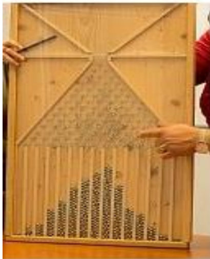
Ex 1. Planchette de Galton (écoulement de billes au travers d'une pyramide de clous)
